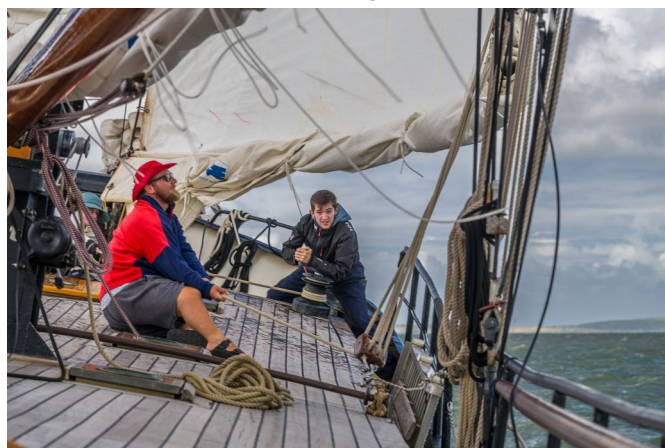
Durchsetzen der Fock mit Reff
